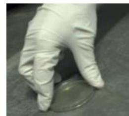
Afin d'obtenir un échantillonnage de l'ensemble de la salle, on va donc en utiliser plusieurs en fonction des différentes surfaces ou zones à contrôler à des niveaux accessibles aux animaux (sol, parois, auge... ).
