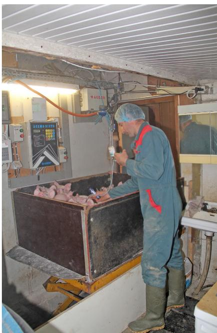
Photo 1 : Une table élévatrice fabriquée « maison » par Mickaël Cardin, éleveur à St Igneuc (22) et placée sur le passage entre la maternité et les PS permet de grouper les porcelets à vacciner et les amener à hauteur désirée au moyen d'une pompe actionnée à la main.
